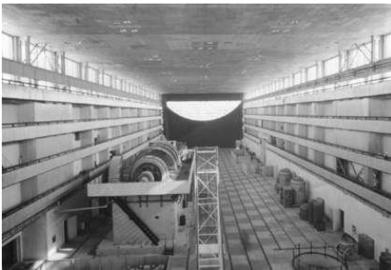
Имитатор серпа Земли стенда КМС-II. На заднем плане - зеркальный экран и слабо отражающая маска
